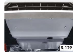
Serie GMS | Motor- und Getriebebeschutz
