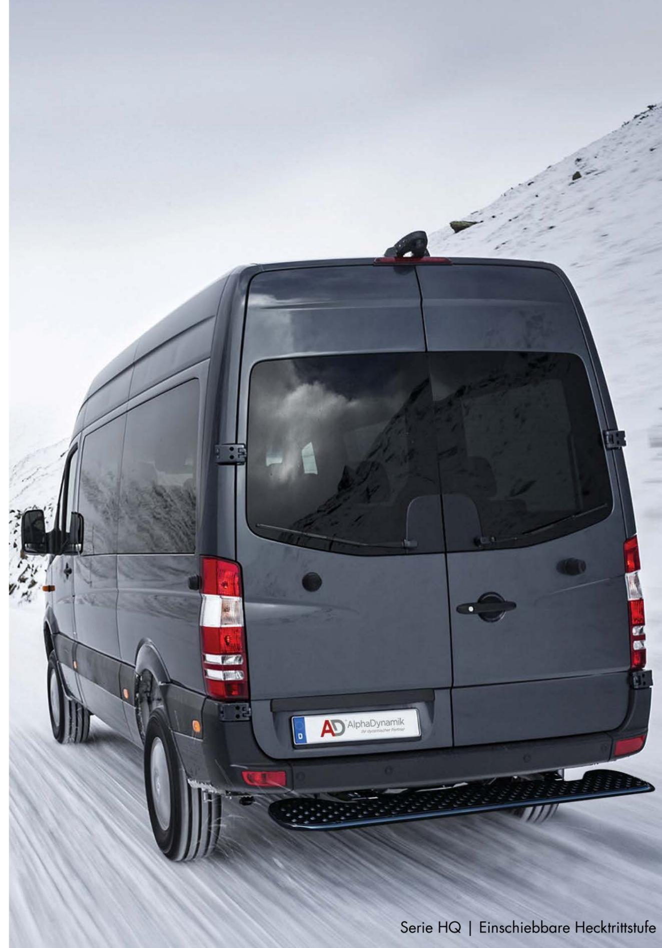
Serie HQ | Einschiebbare Hecktrittstufe
