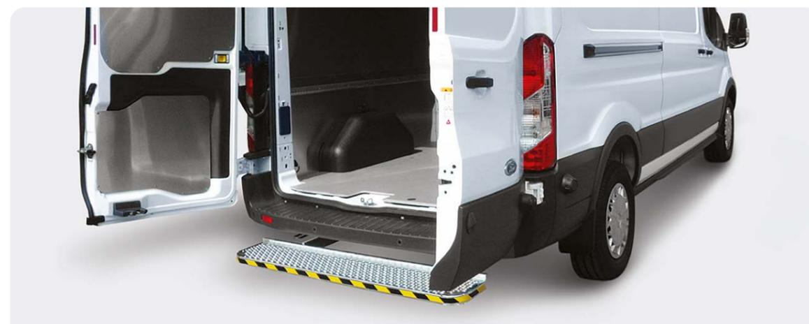
HTF Stufe mit reflektierendem Warnaufkleber
