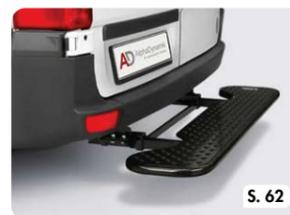
Serie HQ | Einschiebbare Hecktrittstufe
