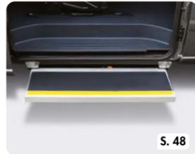
Serie ESE | Seitliche vollautomatische Kassettenstufe
