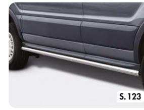
Serie Protec | Seitenschweller-schutzrohre aus Edelstahl
