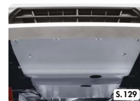
Serie GMS | Motor- und Getriebebeschutz
