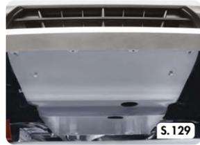
Serie GMS | Motor- und Getriebebeschutz
