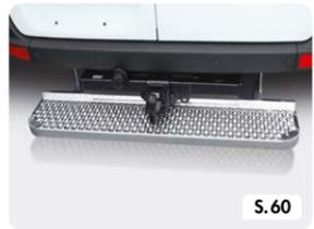
Serie HTF | Hecktrittstufe aus Stahl feuerverzinkt
