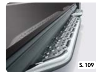
Serie Tour | Schwellerschutz mit integriertem Trittbrett
