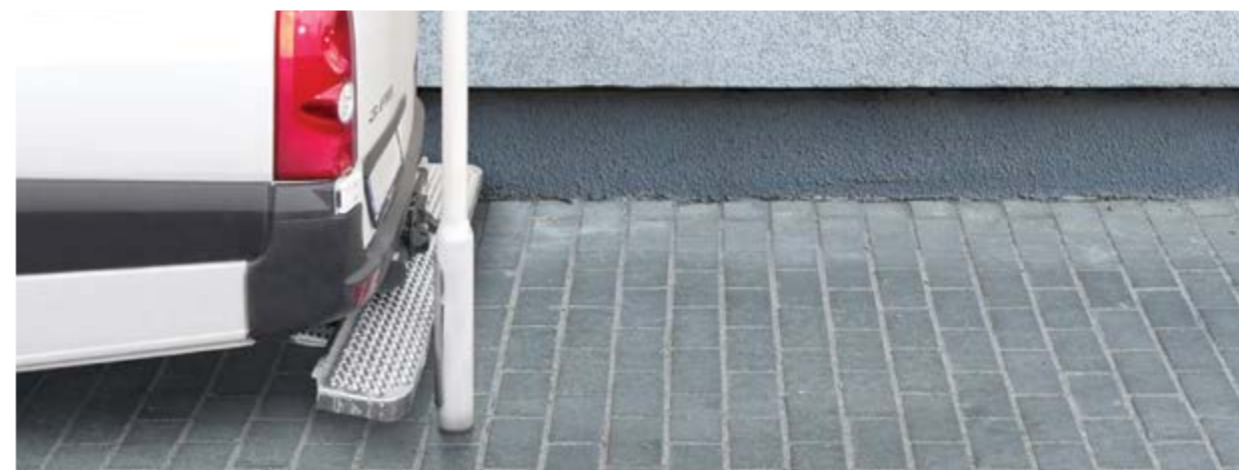
Bei Kontakt mit Hindernis in voller Tiefe einschiebbar
