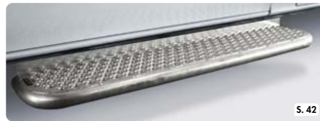
Serie ST | Seitliche starre Trittstufe
