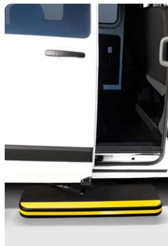
Trittstufe bereits komplett ausgefahren, wenn die Tür halb geöffnet ist
