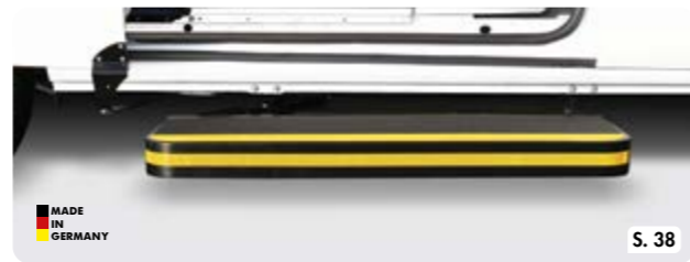
Serie X3 | Mechanische türkombinierte Trittstufe
