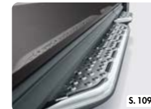
Serie Tour | Schwellerschutz mit integriertem Trittbrett
