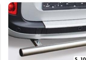
Serie Montana | Heckschutzrohre aus Edelstahl
