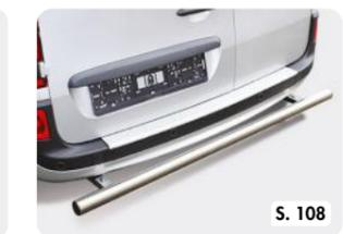
Serie Montana | Heckschutzrohre aus Edelstahl
