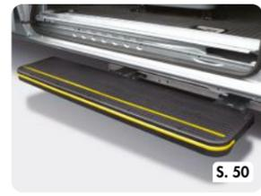
Serie SCE | Seitliche Heavy-Duty elektrische Schwenk-Trittstufe
