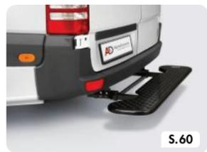
Serie HQ | Einschiebbare Hecktrittstufe
