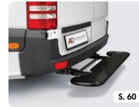
Serie HQ | Einschiebbarer Hecktrittstufe
