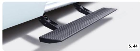
Serie ETB | Seitliche vollautomatische Trittstufe elektrisch
