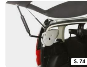
Serie ATG | Elektrischer Antrieb für Heckklappe
