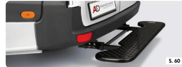
Serie HQ | Einschiebbare Hecktrittstufe
