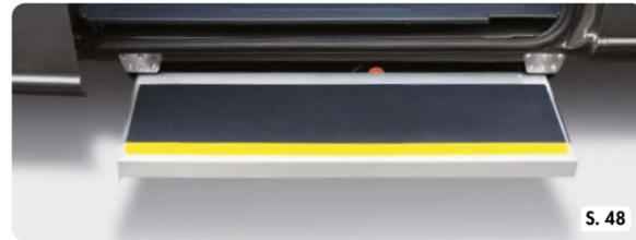
Serie ESE | Seitliche vollautomatische Kassettenstufe
