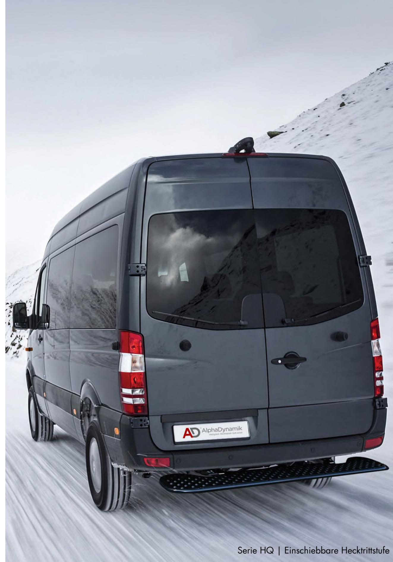
Serie HQ | Einschiebbare Hecktrittstufe
