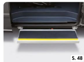
Serie ESE | Seitliche vollautomatische Kassettenstufe
