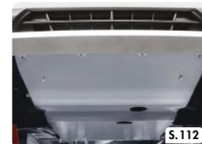
Serie GMS | Motor- und Getriebebeschutz
