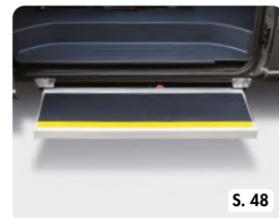
Serie ESE | Seitliche vollautomatische Kassettenstufe
