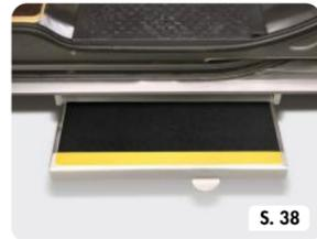
Serie ESM | Seitliche manuelle Kassettenstufe
