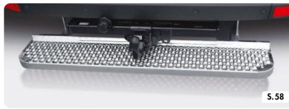
Serie HTF | Hecktrittstufe aus Stahl feuerverzinkt
