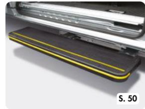
Serie SCE | Seitliche Heavy-Duty elektrische Schwenk-Trittsstufe
