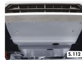
Serie GMS | Motor- und Getriebebeschutz
