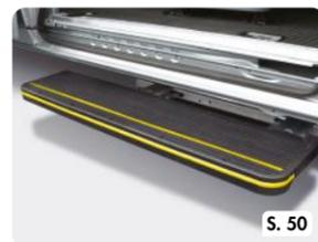
Serie SCE | Seitliche Heavy-Duty elektrische Schwenk-Trittstufe
