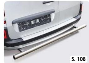
Serie Montana | Heckschutzrohre aus Edelstahl
