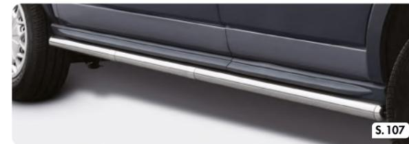
Serie Protec | Seitenschweller-schutzrohre aus Edelstahl
