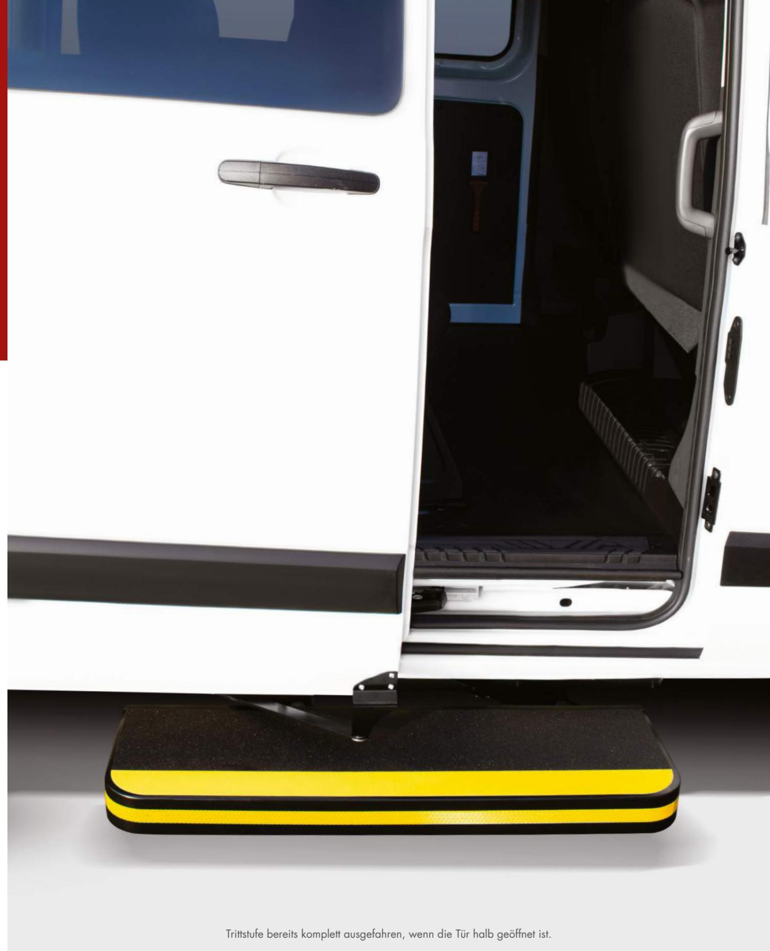
Trittstufe bereits komplett ausgefahren, wenn die Tür halb geöffnet ist.
